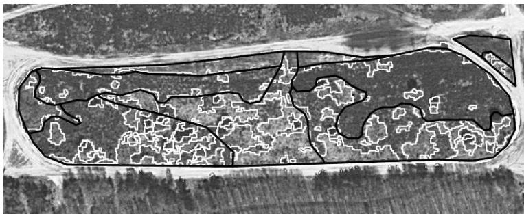
Abb. 3: Vergleich der Kartiererergebnisse einer Feldkartierung (schwarz) und der Ergebnisse der Bildsegmentierung (weiß)
